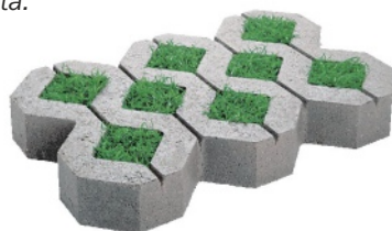
Ukázka řešení „bezodtokového“ parkoviště. Dešťová voda se vsakuje do propustných vrstev pod ním. Zachycení ropných látek je zajištěno sorbentem, který je v otvorech vegetačních tvárníc. Při běžných úkapech se dá bez problémů provozovat cca 25 let, což je v podstatě životnost i vlastních tvárníc.
